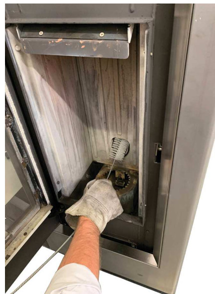
Fig. 41 - Limpieza con escobilla
