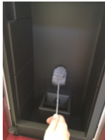
Fig. 36 - Limpieza con escobilla
