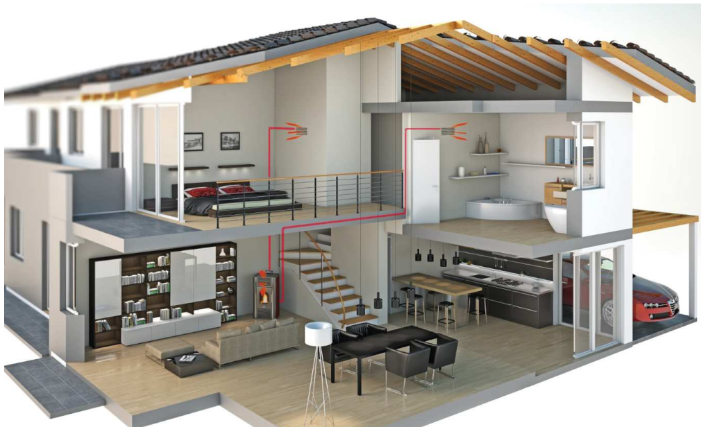
Fig. 108 - Ejemplo de canalización
