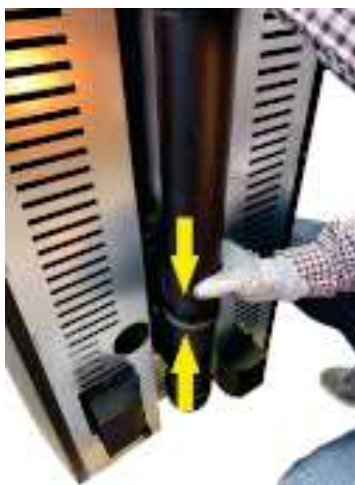
Fig. 74 - Conecte los tubos
