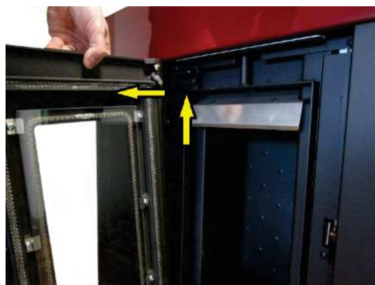
Fig. 20 - Desmontaje de la puerta
