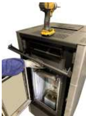
Fig. 25 - Desenganche el panel superior
