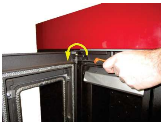
Fig. 19 - Extracción de los tornillos
