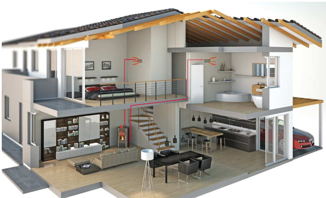
Fig. 14 - Ejemplo de canalización – Spin Wood Plus
