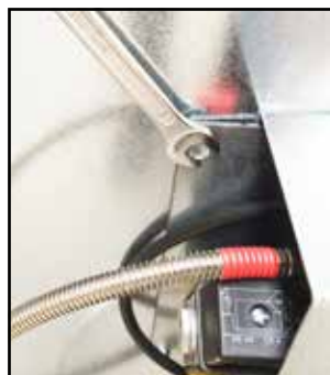
4 vijzen in de hoeken losschroeven (sleutel 8) Desenrosque los 4 tornillos con llave del nº8
