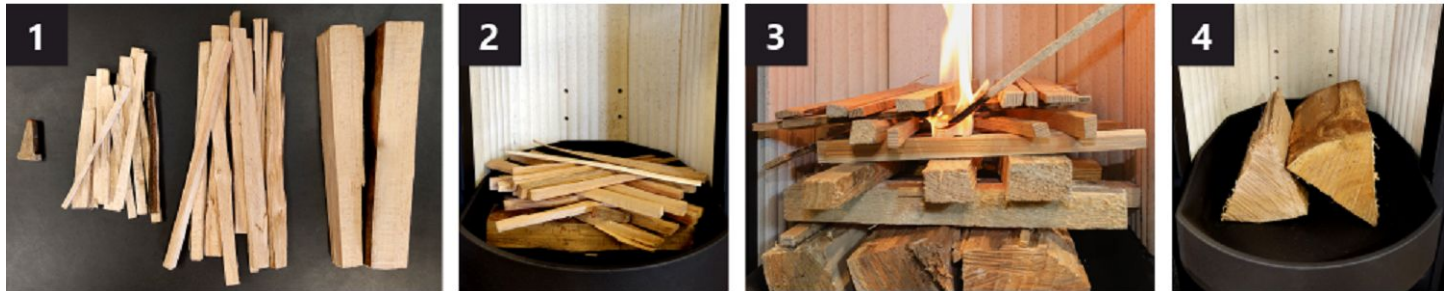
Abb. 1 Holzvorbereitung in der Brennkammer
