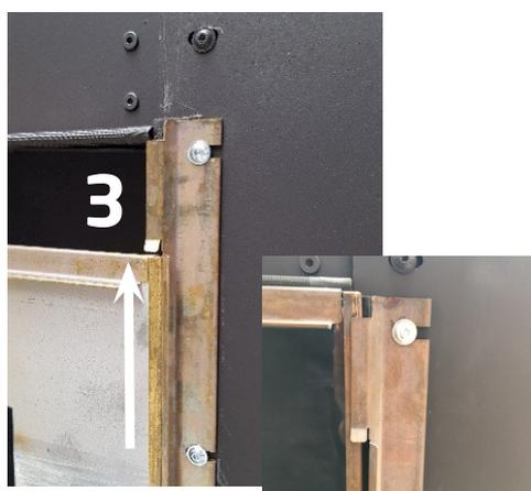
3. La puerta sube automáticamente y estará en la posición cerrada después de deslizarse detrás del perfil.
