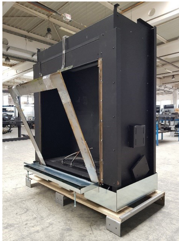
Puerta completamente abierta: la placa basculante debe estar inclinada como en la imagen
