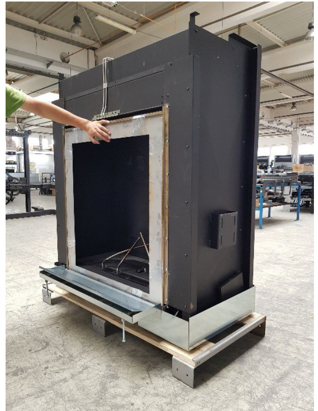
En la apertura de la puerta, la placa basculante se inclina
