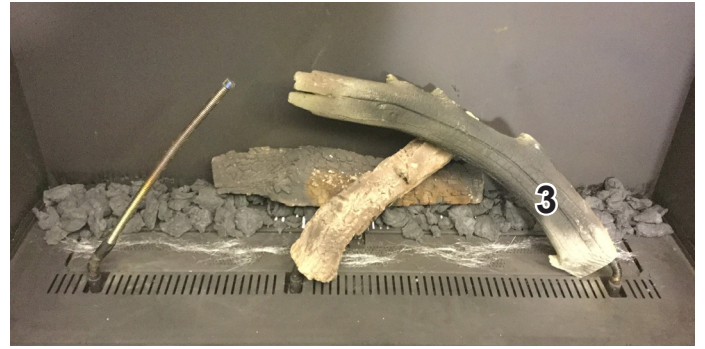
Tronco 3 (con agujero) sobre el quemador flexible.
