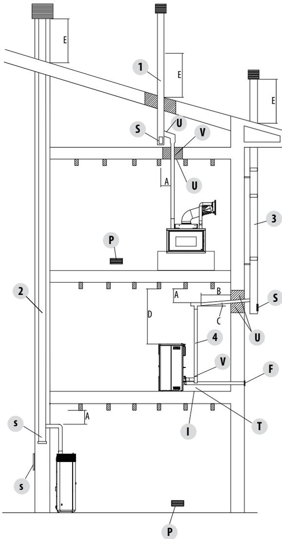
1. Instalación de un conducto de evacuación de humos con orificio para el paso del tubo aumentado con:
