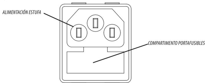
(5x20 mm T retardado/3,15 A 250 V) que es posible que sean necesario sustituir si la estufa no recibe alimentación (por ejemplo: la pantalla del panel de control no se ilumina); operación a cargo de un técnico autorizado y cualificado.
