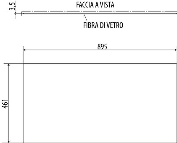
MATERIAL GRES PORCELÁNICO ESPESOR 3,5 MM
