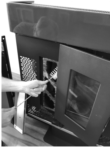
Fig. 37 - Limpieza con escobilla
