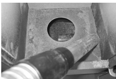
Fig. 31 - Limpieza alojamiento cajón de cenizas
