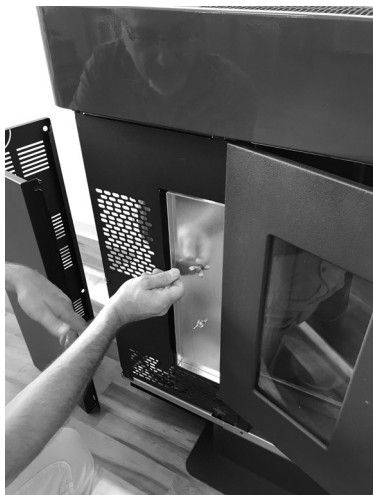
Fig. 35 - Desenrosque los tornillos
