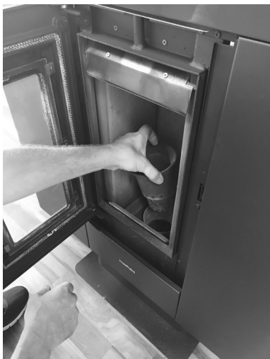
Fig. 28 - Extracción del brasero
