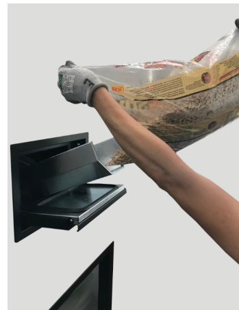
Fig. 38 - Cargar pellet con rampa
