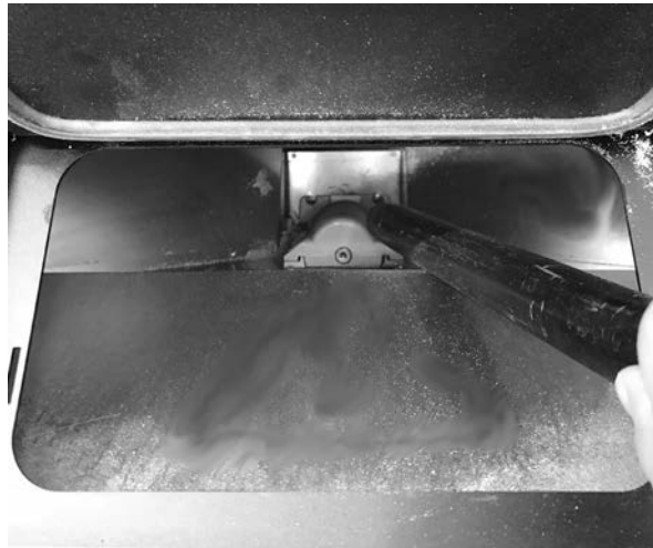
Fig. 33 - Limpieza depósito y coclea
