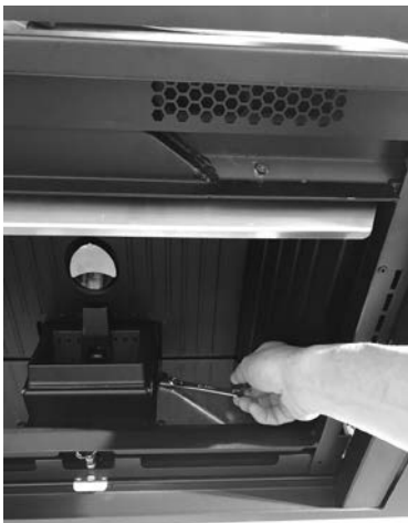
Fig. 34 - Extracción de los pisos
