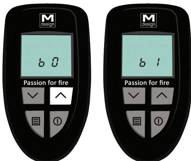
Nota: Si después de un uso anterior de la chimenea, la ha apagado en el modo "b1", en el próximo encendido, los quemadores 1 y 2 se encenderán simultáneamente. Si por el contrario hubiera apagado la chimenea en modo "b0", la chimenea solo se encenderá con el quemador 1.
