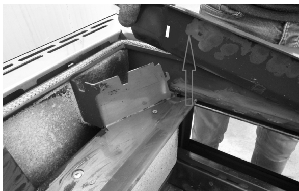
Fig. 31 - Rimuovere profilo frontale
