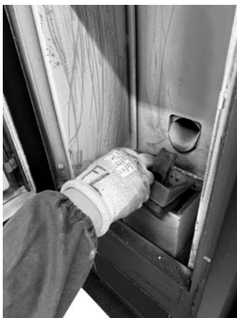
Fig. 33 - Extracción del brasero
