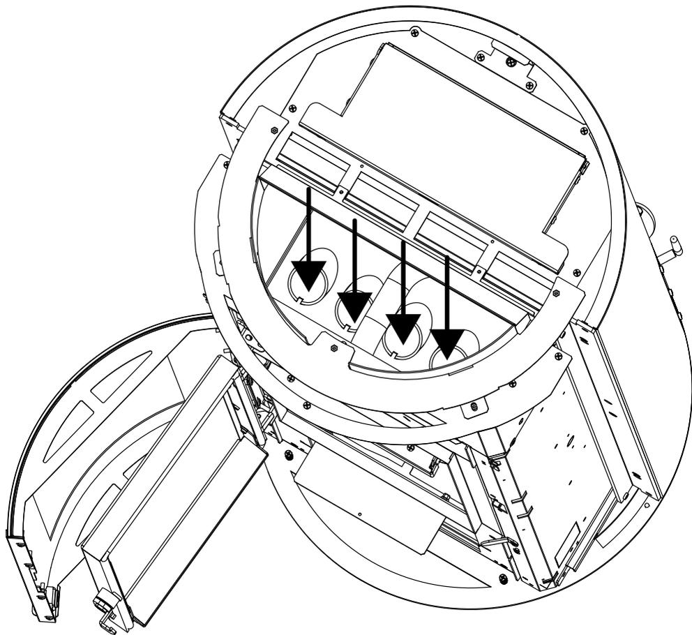
Después, limpie bien el intercambiador inferior; cambie las juntas y vuelva a montar todo.
