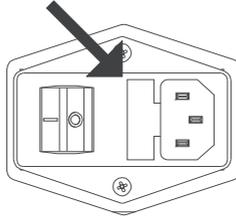
Si al efectuar el nuevo encendido, presionando el interruptor general situado en el costado del producto, el visualizador del panel de mandos no se enciende, querrá decir que es necesario cambiar el fusible de servicio.
