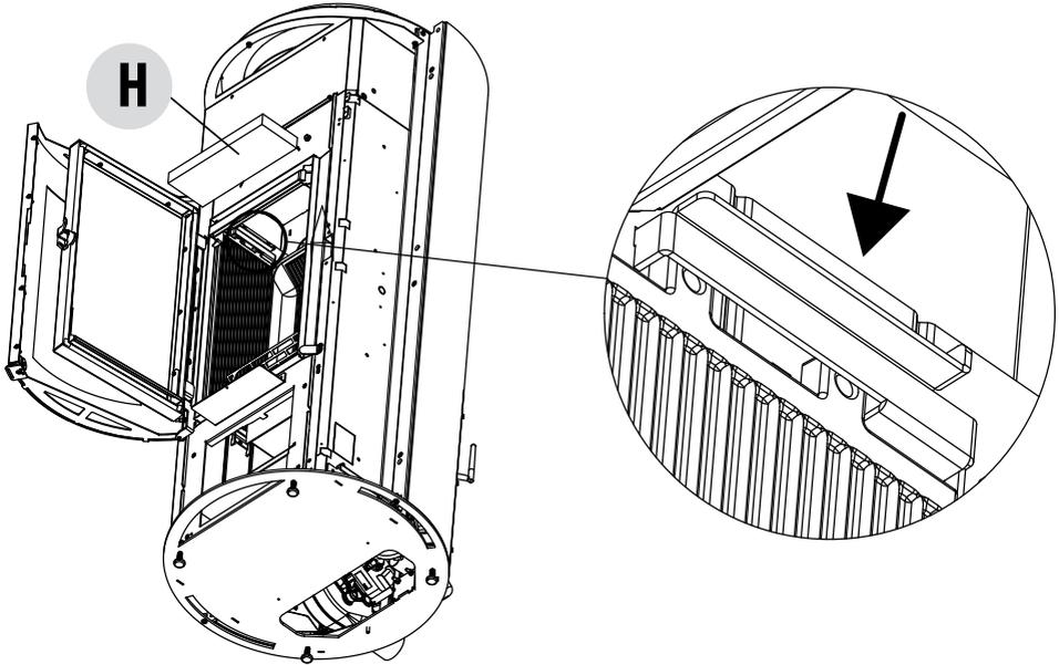
Con la boquilla del aspirador, aspire la ceniza y el polvo acumulados encima del intercambiador (véase la flecha).
