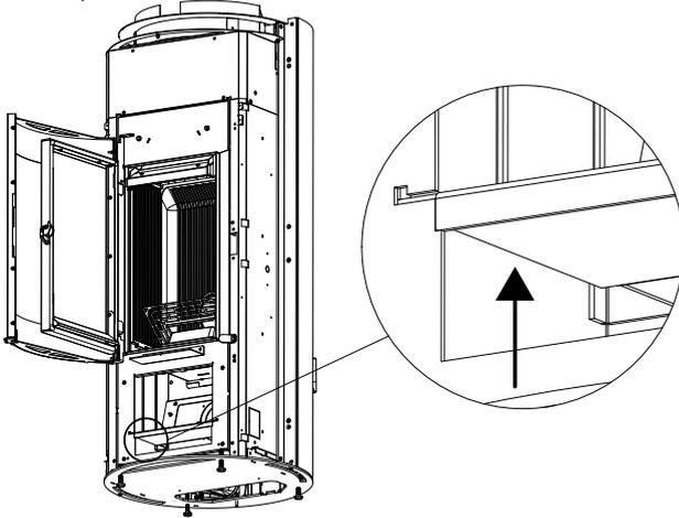
Después, quite la plancha de calorita superior "H"; para ello, abra la puerta del hogar, arriba con las manos, levante la placa de calorita "H", inclínala hacia la derecha o la izquierda para hacerla salir de los soportes y retírela.
