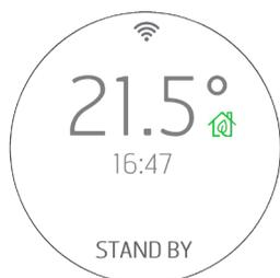
Quando la temperatura ambiente raggiunge la temperatura impostata e anche tutte gli altri parametri vengono rispettati (vedi paragrafo successivo), l'apparecchiatura si spegne e il display raffigura la temperatura ambiente, l'ora attuale e l'indicazione **STANDBY** per indicare uno stato di attesa che permette al prodotto di riaccendersi appena la temperatura discende sotto la soglia impostata o se si alza la temperatura desiderata in ambiente.
