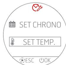
Proseguendo con la programmazione si imposta la modalità scelta per quella fascia oraria e successivamente la ventilazione. Si ricorda che la ventilazione è selezionabile solo in caso di programmazione della modalità AUTO. Nel caso di selezione della modalità COMFORT o OVERNIGHT in corrispondenza del campo ventilazione  $\otimes$ , verranno raffigurati dei trattini --- e non vi è possibilità di modifica.
