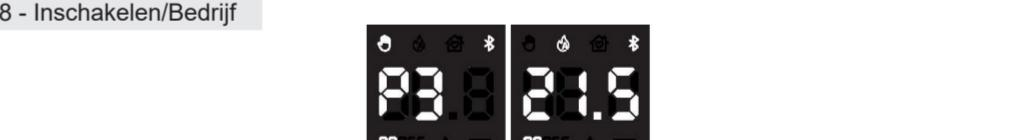
Wanneer de kachel wordt ingeschakeld, wordt het huidige vermogen weergegeven als de handmatige modus is ingesteld, of de kamertemperatuur als de automatische/comfortmodus is ingesteld.
