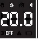
In qualsiasi stato della stufa è sempre permesso l'impostazione del set temperatura (se automatico o comfort) o potenza (se manuale).
