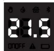
Bei einer gekoppelten Fernbedienung wird, bevor die BLE-Verbindung zwischen der Fernbedienung und dem Ofen korrekt hergestellt ist, die zuletzt übertragene Temperatur angezeigt.
