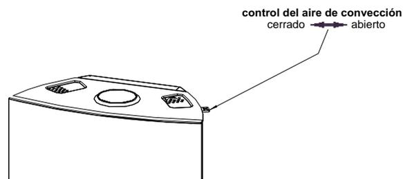
Nuestro consejo: durante la utilización, deje la circulación del aire de convección abierta y posteriormente ciérrela para obtener una restitución de calor regular y prolongada.
