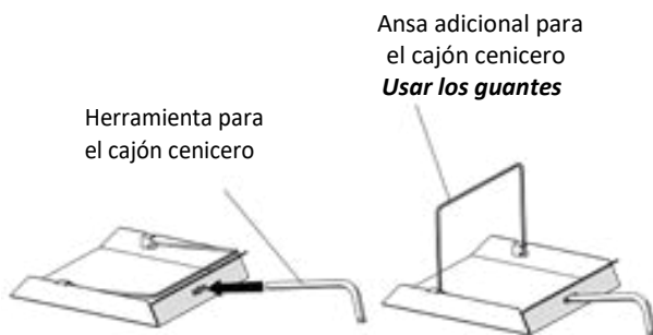
Fig. 3 Eliminación de cenizas
