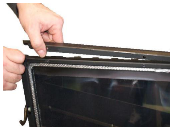
Fig. 116 - Extracción de los perfiles de la puerta
