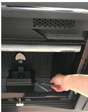
Fig. 108 - Extracción de los pisos
