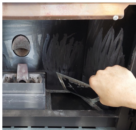
Fig. 102 - Retire la tapa de inspección
