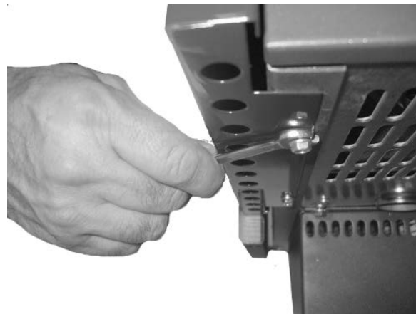
Fig. 30 - Fijación de los paneles
