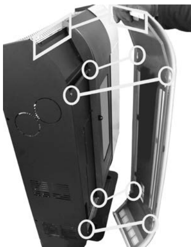
Fig. 31 - Inserción de los paneles
