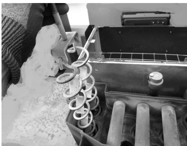
Fig. 96 - Sustitución de los turbuladores si es necesario
