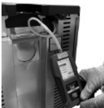
Fig. 110 - Conexión del presostato digital (Atena)
