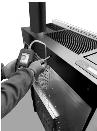
Fig. 111 - Conexión del presostato digital (Mithos)
