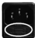
Fig. 133 - Ventanilla con los fusibles de remover
