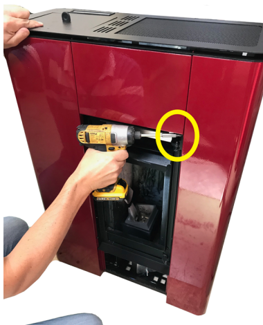
Fig. 51 - Extracción de los tornillos 1
