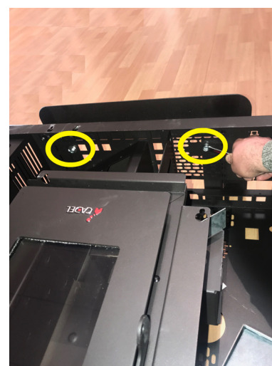
Fig. 74 - Bloquee los tornillos
