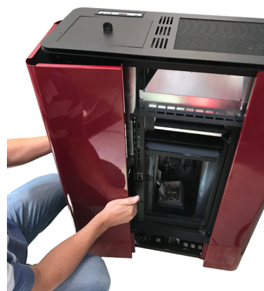
Fig. 55 - Extracción del panel
