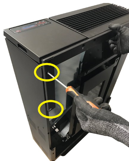
Fig. 42 - Fijación de la abrazadera superior
