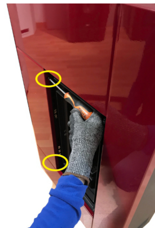
Fig. 33 - Fijación de los tornillos
