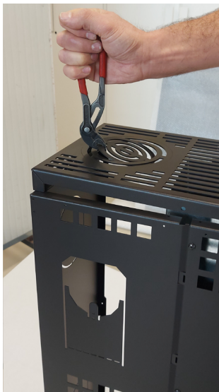
Fig. 70 - Rompe los precortes
