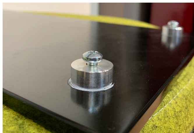
Fig. 44 - El tornillo debe sobresalir
