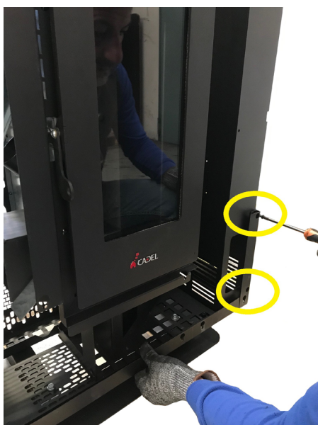
Fig. 34 - Fijación de la abrazadera inferior
