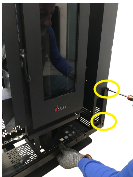
Fig. 41 - Fijación de la abrazadera inferior
