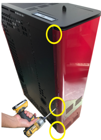
Fig. 54 - Extracción de los tornillos 4
