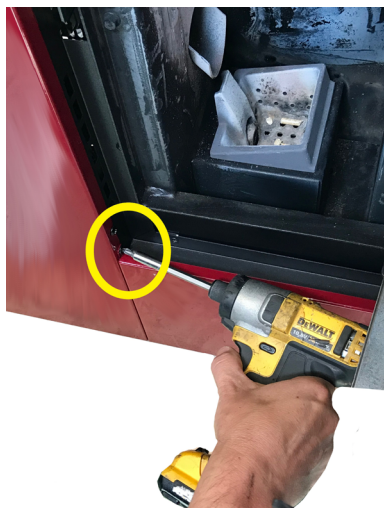
Fig. 50 - Extracción de los tornillos 1
