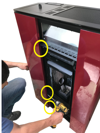
Fig. 53 - Extracción de los tornillos 3
