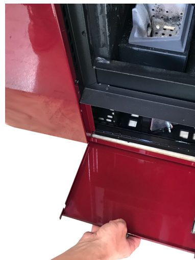
Fig. 52 - Desmontaje de las placas frontales delanteras
