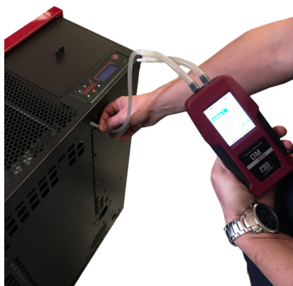
Fig. 85 - Conexión de presostato digital
