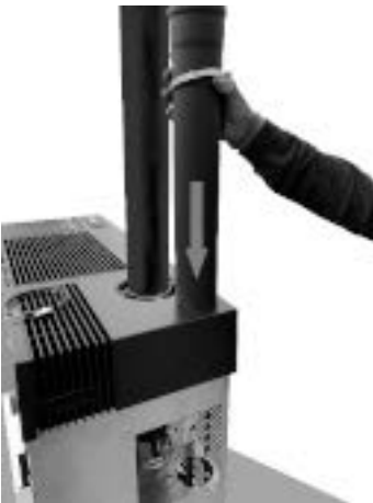
Fig. 98 - Das Kanalisationsrohr einführen
