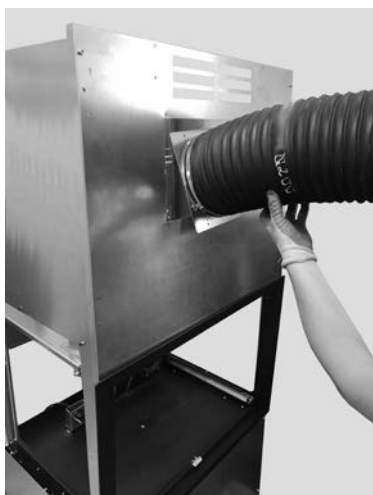
Fig. 72 - Colocación del tubo flexible
