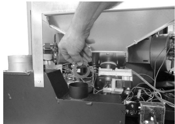
Fig. 37 - Extracción del anillo 2
