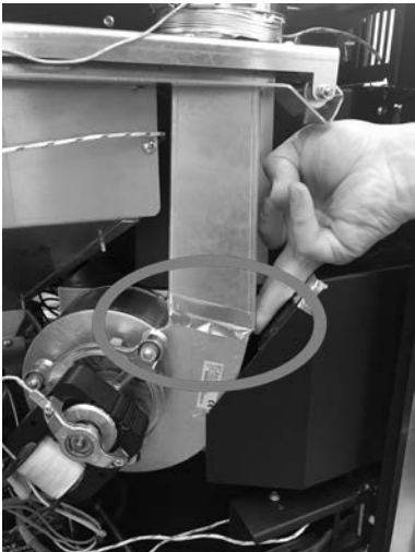
Fig. 54 - Selle con cinta adhesiva de aluminio
