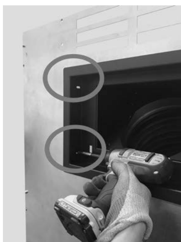
Fig. 74 - Fijación del exterior de la trampilla
