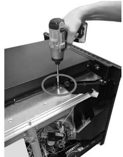
Fig. 63 - Fijación central del cajón
