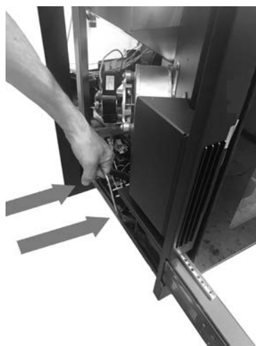
Fig. 31 - Extracción del cuerpo de la máquina
