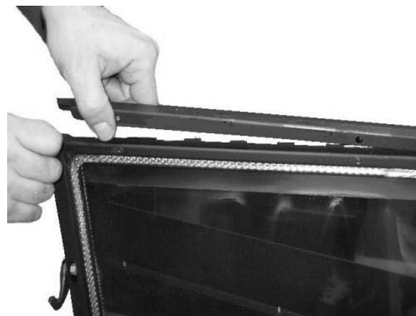
Fig. 105 - Extracción de los perfiles de la puerta
