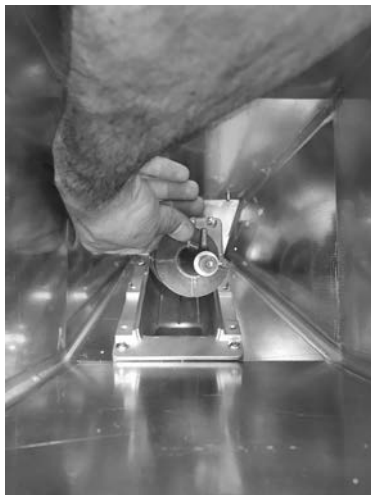
Fig. 95 - Extracción de la espiral
