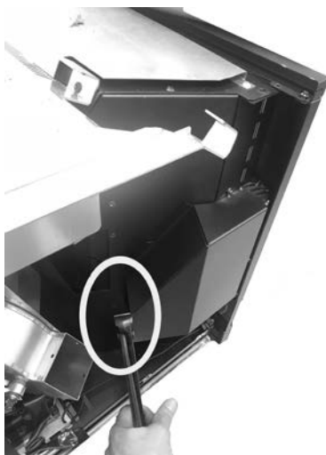
Fig. 46 - Rompa la esquina
