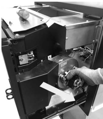
Fig. 100 - Extraiga el ventilador
