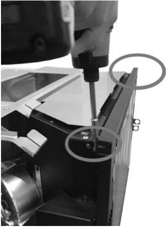
Fig. 58 - Extraiga el perfil superior
