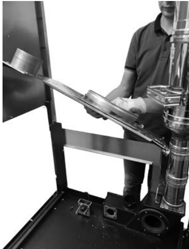
Fig. 65 - Extracción de la tapa
