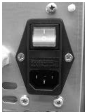
Fig. 35 - Toma de corriente con interruptor general
