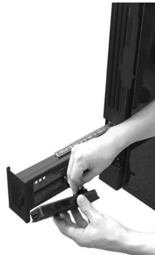
Fig. 91 - Conecte la pantalla y vuelva a colocarla
