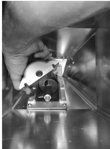
Fig. 93 - Extracción de la cobertura
