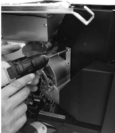
Fig. 45 - Extraiga el ventilador
