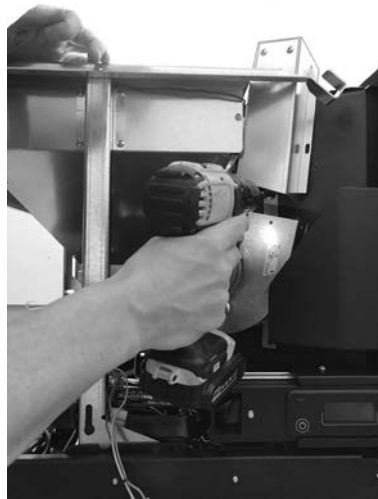
Fig. 52 - Fije el ventilador
