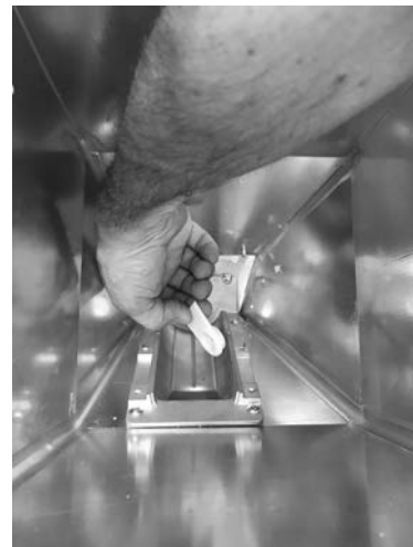
Fig. 96 - Extracción del cojinete
