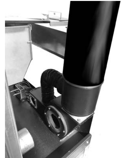
Fig. 85 - Conexión al tubo de salida de humos
