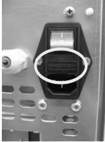
Fig. 106 - Ventanilla con los fusibles de remover
