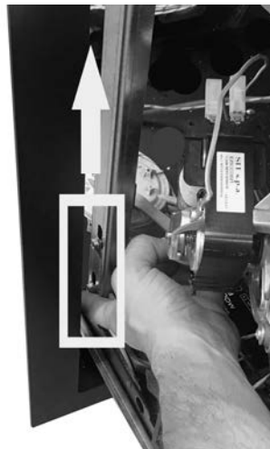
Fig. 29 - Elevar la placa de bloqueo
