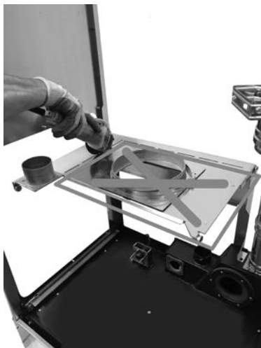
Fig. 67 - Cortar la tapa
