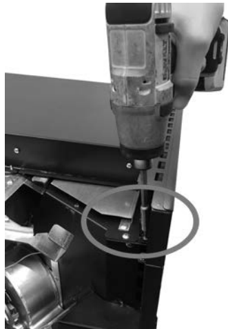
Fig. 62 - Fijación delantera del cajón
