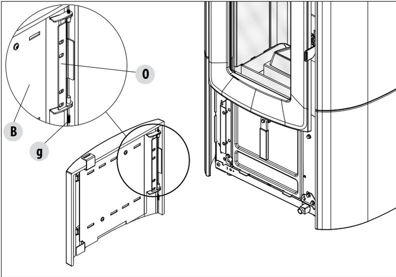
Seguidamente, fije la cerámica "B" en la estructura de la estufa mediante los dos tornillos "j".
