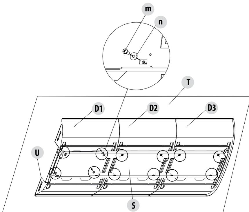
Una vez concluida la fijación bastidor/cerámicas quite los dos tornillos "k" y retire la plantilla "U".
