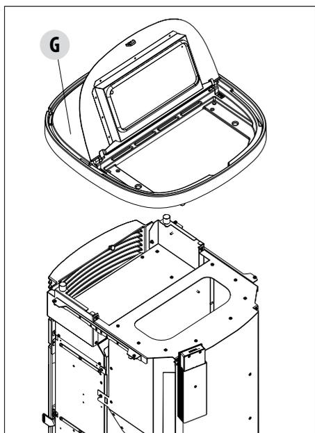
Levante la tapa de pellet "W", retire los dos tornillos "x" y retire la parte superior completa "G".
