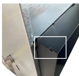
deslice el listón superior para que coincidan los encajes entre sí.
