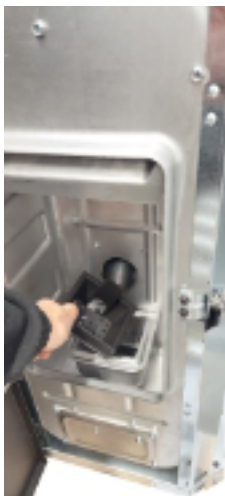
Fig. 33 - Extracción del brasero
