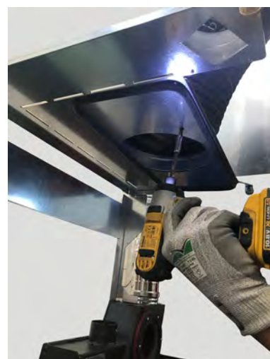
Fig. 68 - Fijar el tubo flexible
