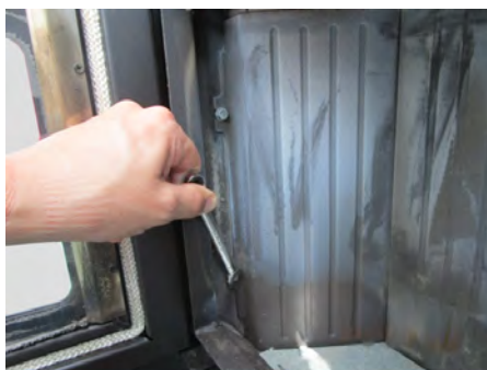
Fig. 109 - Extracción de los tornillos
