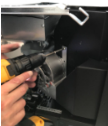
Fig. 40 - Extraiga el ventilador
