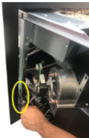
Fig. 23 - Afloje los tornillos
