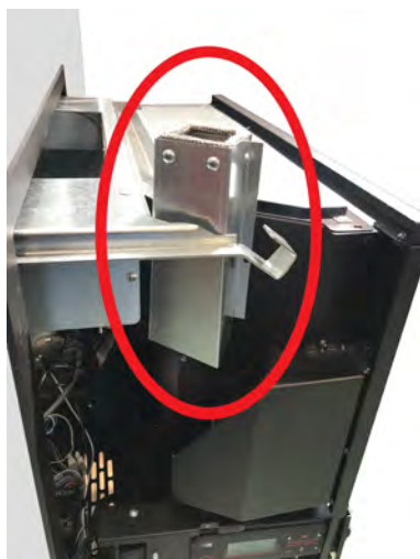
Fig. 46 - Coloque el desviador del aire
