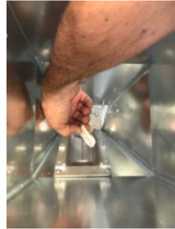
Fig. 94 - Extracción del cojinete
