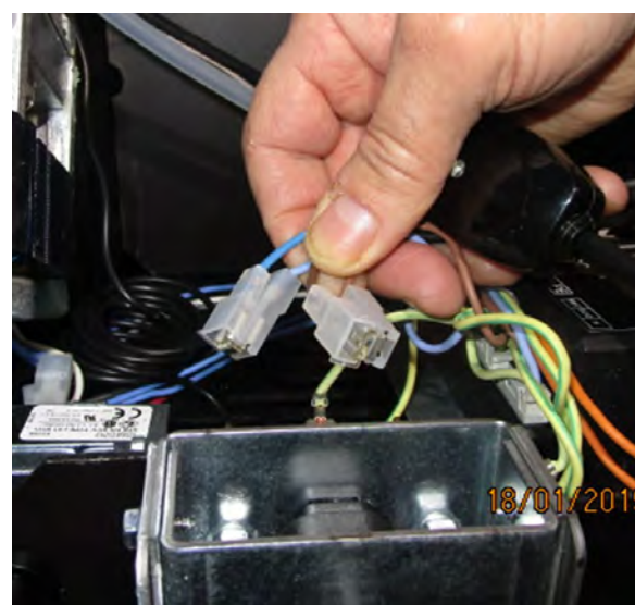
Fig. 88 - Conexión de los terminales faston dobles
