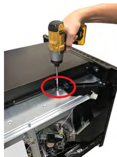
Fig. 57 - Fijación central del cajón
