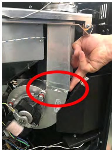
Fig. 49 - Selle con cinta adhesiva de aluminio
