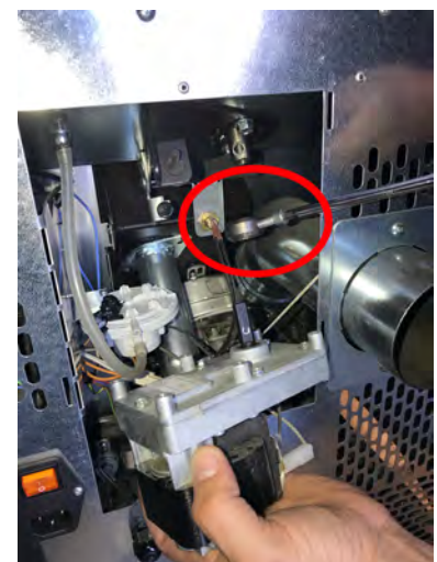
Fig. 92 - Extracción del motorreductor
