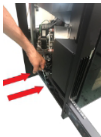
Fig. 26 - Extracción del cuerpo de la máquina
