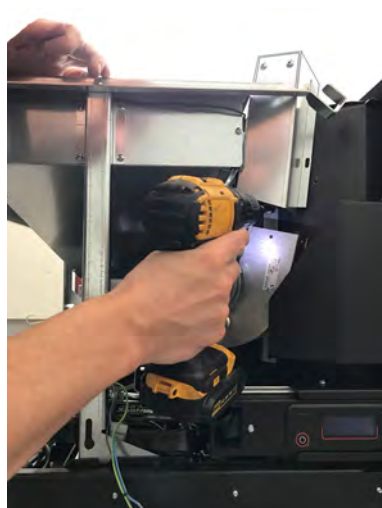
Fig. 47 - Fije el ventilador
