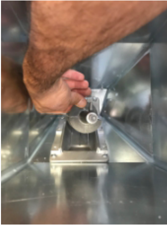
Fig. 93 - Extracción de la espiral
