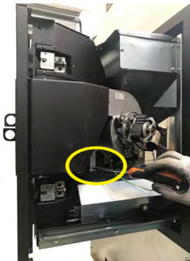
Fig. 97 - Extraiga el ventilador
