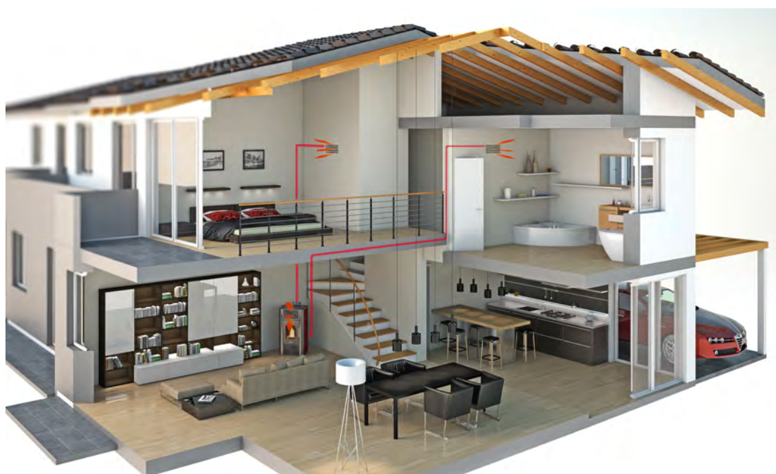
Fig. 52 - Ejemplo de canalización
