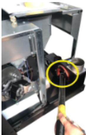
Fig. 114 - Limpieza del canal de humo
