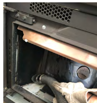
Fig. 107 - Aspire las cenizas
