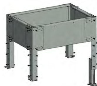
Fig. 37 - Monte las patas y el alargador
