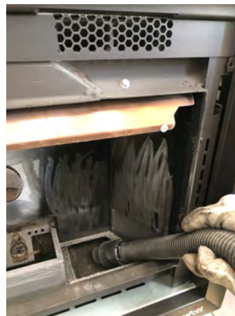
Fig. 104 - Aspire las cenizas
