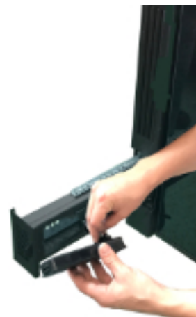
Fig. 85 - Conecte la pantalla y vuelva a colocarla
