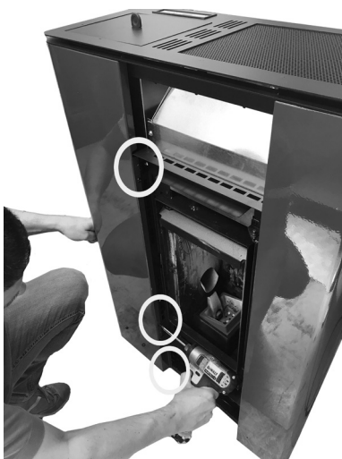
Fig. 43 - Extracción de los tornillos 3
