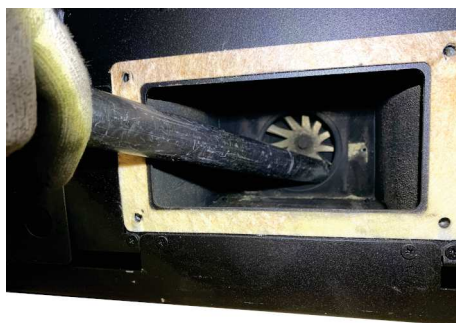
Fig. 82 - Aspire las cenizas
