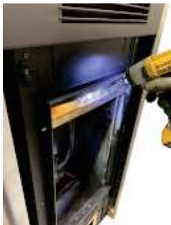
Fig. 71 - Retire el deflector
