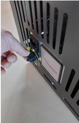
Fig. 63 - Desenrosque la tuerca
