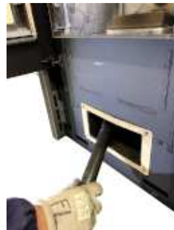
Fig. 69 - Aspire las cenizas
