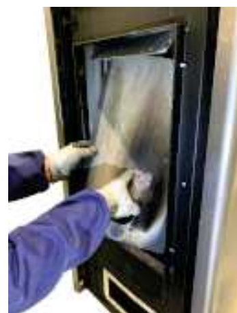
Fig. 76 - Extraiga la parte trasera del hogar
