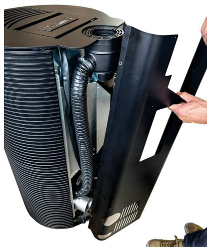
Fig. 26 - Desmontaje de la parte trasera
