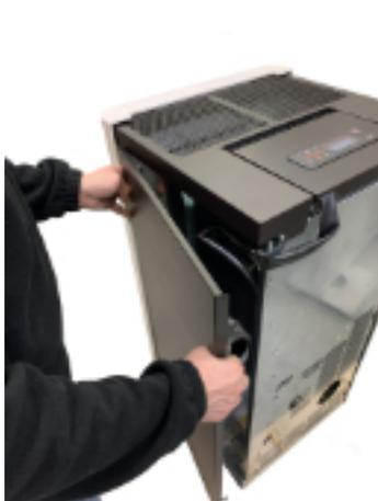
Fig. 36 - Desenganche las paredes laterales
