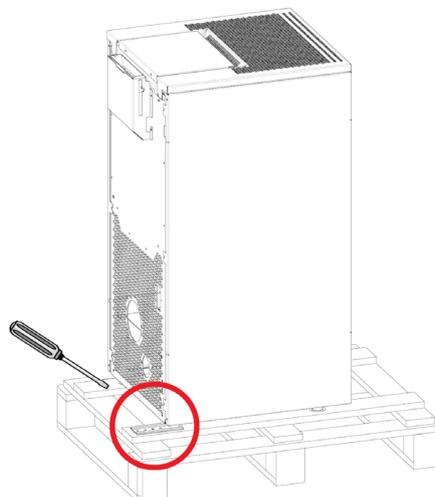
*Fig. 1 - Extracción de las abrazaderas*
