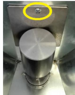
**Fig. 88 - Retirada del tornillo**
