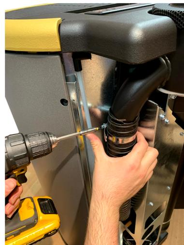
Fig. 64 - Retirar el tubo flexible
