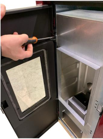
Fig. 29 - Extracción de los tornillos
