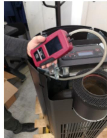
Fig. 74 - Conexión del presostato digital 2
