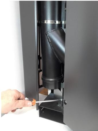
**Fig. 77 - Desatornille el tope de la tapa**
