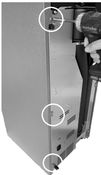
Fig. 38 - Retire los tornillos
