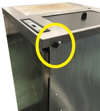
Fig. 72 - Extracción del tapón
