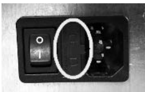
Fig. 75 - Ventanilla con los fusibles de remover
