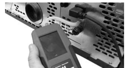
Fig. 53 - Conexión del presostato digital Quasimod³ Up
