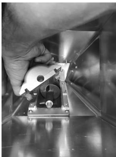
Fig. 55 - Extracción de la cobertura
