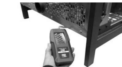
Fig. 52 - Conexión del presostato digital Frame²
