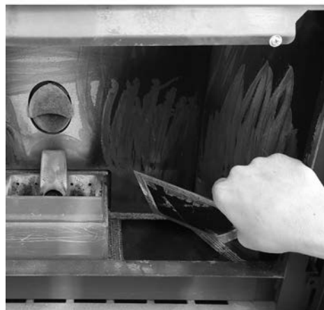
Fig. 69 - Retire la tapa de inspección
