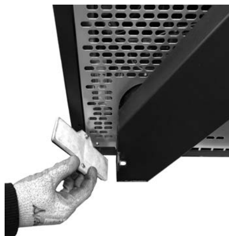
Fig. 67 - Limpieza canal de humos
