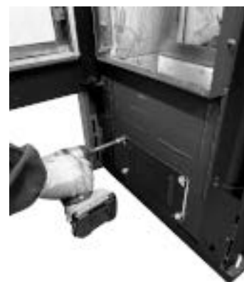
Fig. 74 - Retire la tapa
