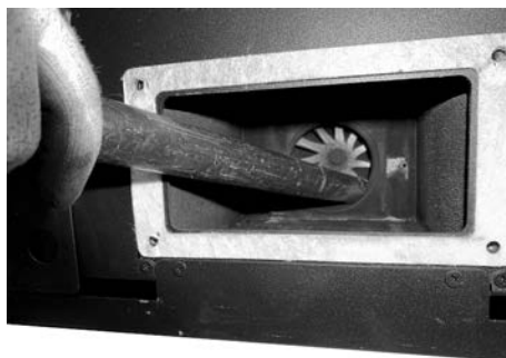
Fig. 87 - Aspire las cenizas
