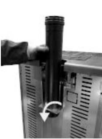
Fig. 48 - Baje el soporte
