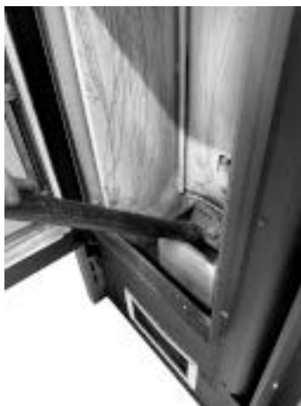
Fig. 73 - Aspire las cenizas
