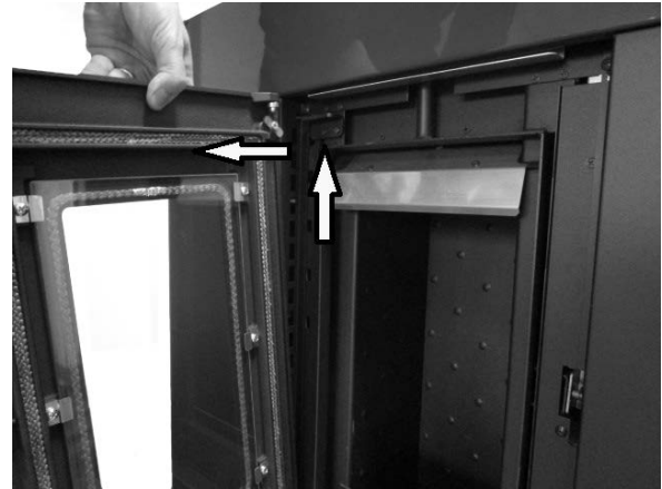
Fig. 20 - Desmontaje de la puerta
