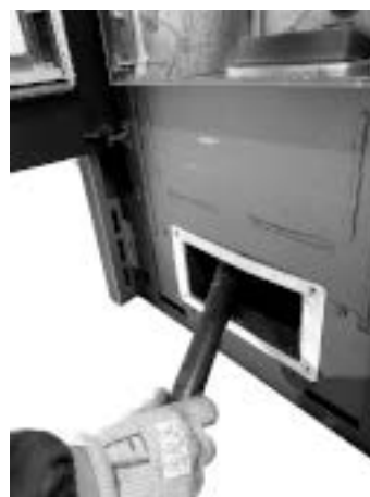
Fig. 76 - Aspire las cenizas
