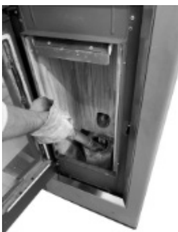
Fig. 34 - Limpieza alojamiento brasero
