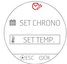
Prosiguiendo con la programación se configura la modalidad elegida para dicha franja horaria y, después, la ventilación. Cabe recordar que la ventilación solo puede seleccionarse en caso de programación de la modalidad AUTO. Si se selecciona la modalidad COMFORT o OVERNIGHT en el campo de ventilación  $\text{OFF}$ , aparecerán unos guiones --- y no existe la posibilidad de modificación.
