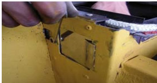
14. Mit einem 8mm-Gabelschlüssel und Steckschlüssel das Verschlussblech der linken Öffnung entfernen.
