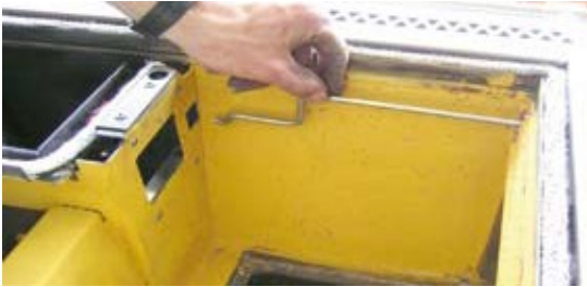
12. Das Gestänge der Anheizklappe nach vorne herausziehen
