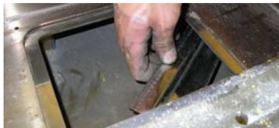
7. Verschlusschale des Rauchgasweges aus seiner rechten Halterung herausziehen.
