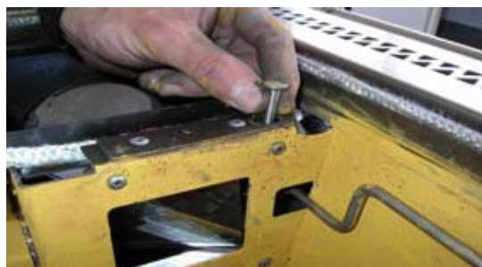
10. Scharnierstift der Anheizklappe heraus-ziehen.
