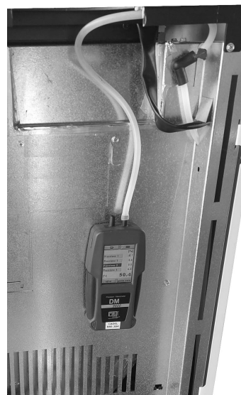
Fig. 39 - Conexión del presostato digital
