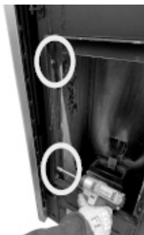
Fig. 49 - Extraiga los tornillos hexagonales
