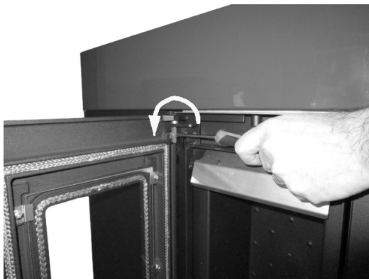
Fig. 17 - Extracción de los tornillos
