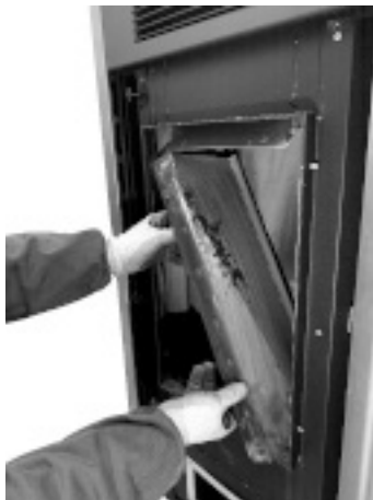
Fig. 52 - Retire las paredes laterales
