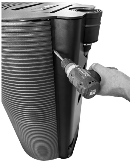
Fig. 19 - Retire los tornillos
