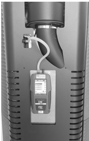
Fig. 38 - Conexión del presostato digital
