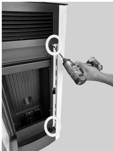
Fig. 28 - Extracción los tornillos
