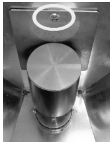
Fig. 64 - Retirada del tornillo
