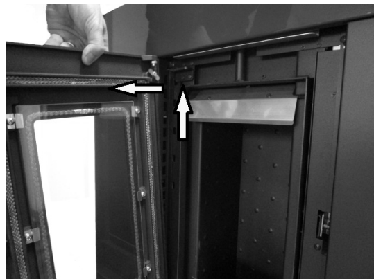
Fig. 18 - Desmontaje de la puerta
