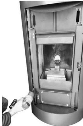
Fig. 24 - Desmontaje de los tornillos de los perfiles (der e izq).
