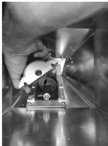
Fig. 47 - Extracción de la cobertura
