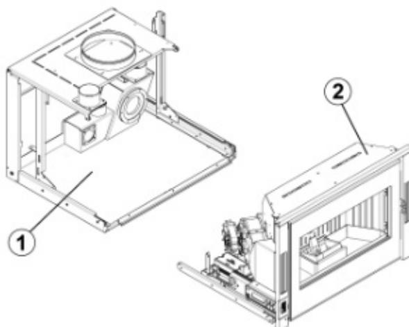
Fig. 20 - Estructura y cuerpo de la máquina
