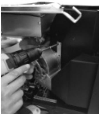
**Fig. 40 - Extraiga el ventilador**
