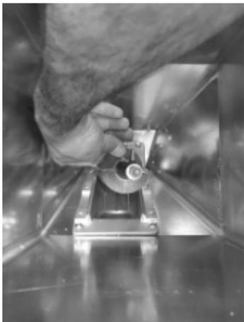
**Fig. 94 - Extracción de la espiral**
