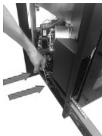
**Fig. 26 - Extracción del cuerpo de la máquina**
