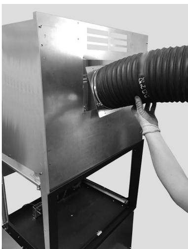
**Fig. 67 - Colocación del tubo flexible**
