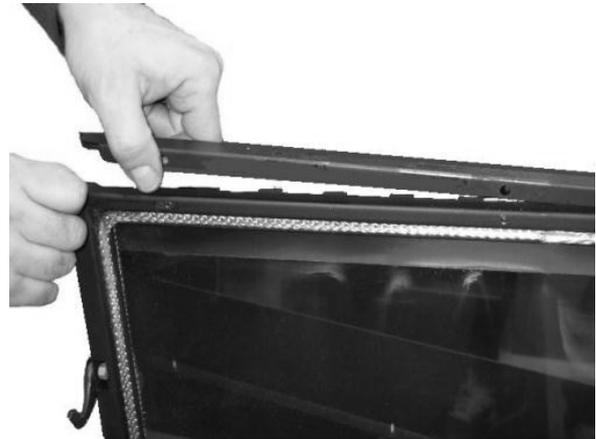
**Fig. 117 - Extracción de los perfiles de la puerta**
