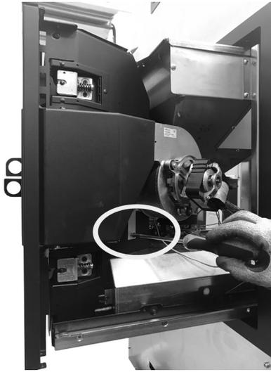
**Fig. 98 - Extraiga el ventilador**
