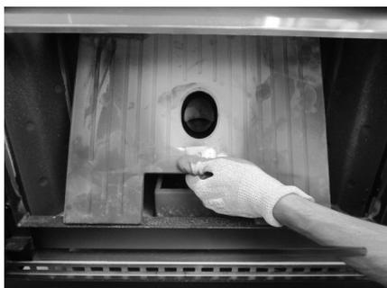
**Fig. 112 - Extracción de la pared central de hierro fundido**
