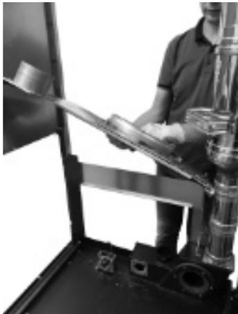
*Fig. 60 - Extracción de la tapa*
