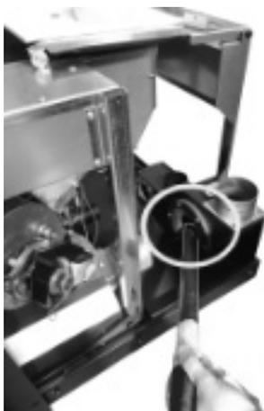
**Fig. 115 - Limpieza del canal de humo**
