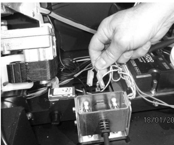
*Fig. 88 - Desconexión del terminal faston (azul - marrón)*
