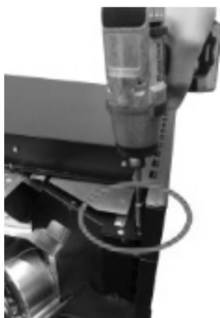
*Fig. 57 - Fijación delantera del cajón*
