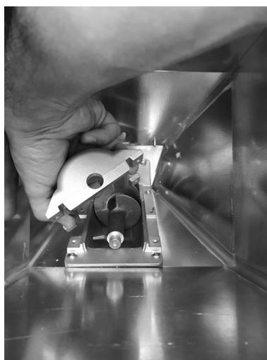
Fig. 92 - Extracción de la cobertura
