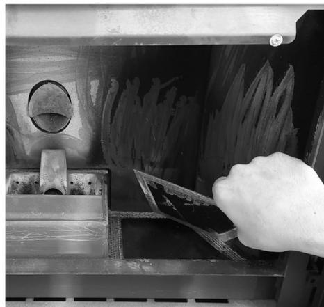
**Fig. 103 - Retire la tapa de inspección**
