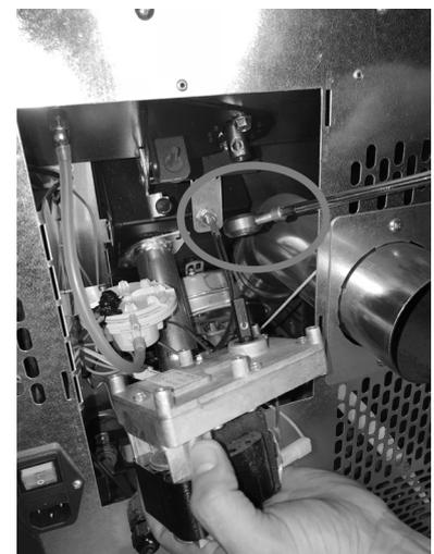
Fig. 93 - Extracción del motorreductor
