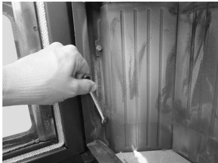
**Fig. 110 - Extracción de los tornillos**
