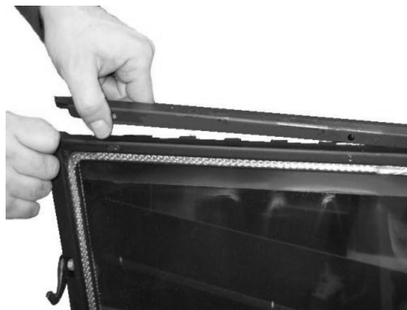
Fig. 117 - Extracción de los perfiles de la puerta
