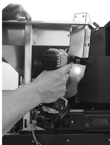
Fig. 47 - Fije el ventilador
