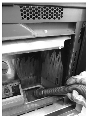
Fig. 105 - Aspire las cenizas
