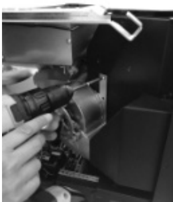
Fig. 40 - Extraiga el ventilador
