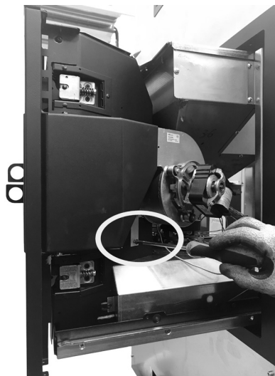
Fig. 98 - Extraiga el ventilador
