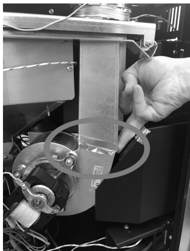
Fig. 49 - Selle con cinta adhesiva de aluminio
