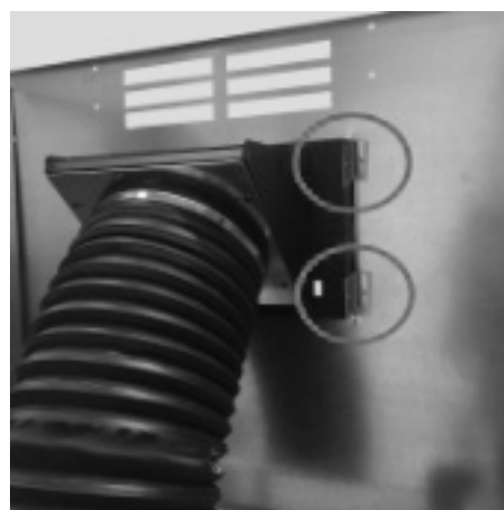
Fig. 71 - Fijación del interior de la trampilla
