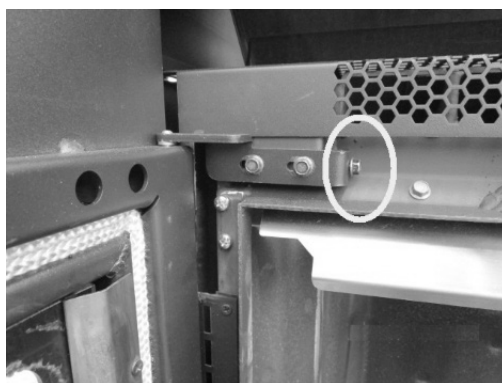
Fig. 29 - Regulación de la puerta
