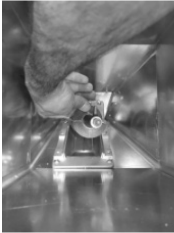
Fig. 94 - Extracción de la espiral
