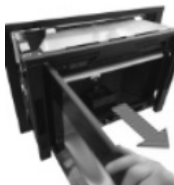
Fig. 22 - Extracción del cuerpo de la máquina
