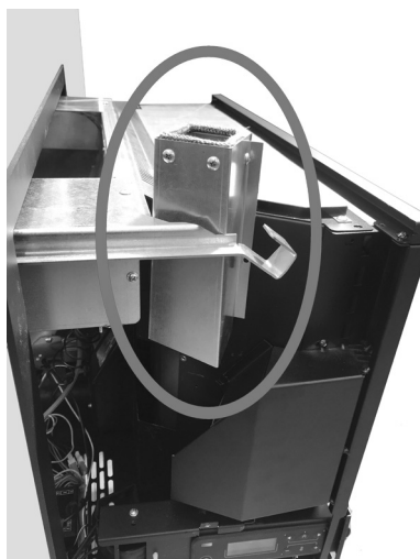
Fig. 46 - Coloque el desviador del aire
