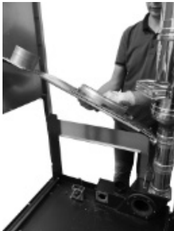
Fig. 60 - Extracción de la tapa
