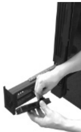
Fig. 86 - Conecte la pantalla y vuelva a colocarla
