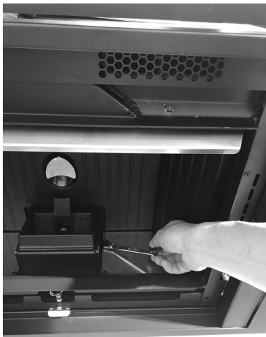
Fig. 109 - Extracción de los pisos
