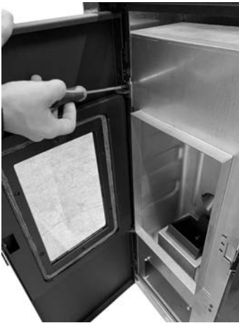
Fig. 24 - Extracción de los tornillos
