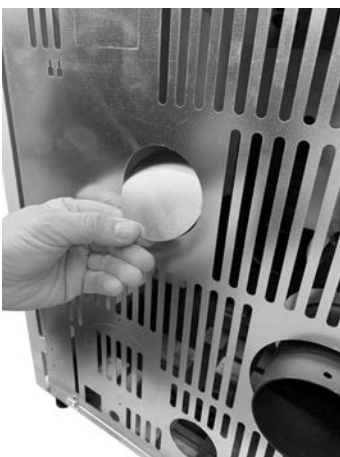
Fig. 51 - Extracción del anillo
