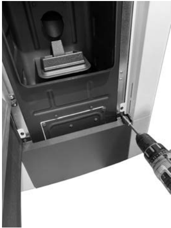
Fig. 37 - Extracción de los tornillos
