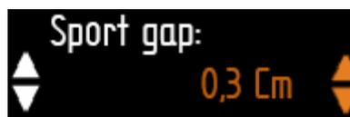
**Sport gap (combustion sportive)** : de 0,1 a 2cm (de 0,1cm en 0,1cm). En cualquier momento se puede reavivar el fuego. Esto se realiza mediante la apertura del cristal ligeramente. Esto permite al fuego, recibir un suministro adicional de oxígeno. "Sport gap" permite determinar la abertura del cristal.
