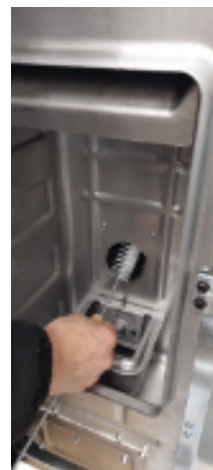
Fig. 38 - Limpieza con escobilla
