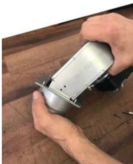
Fig. 32 - Fija la abrazadera + racor del ventilador
