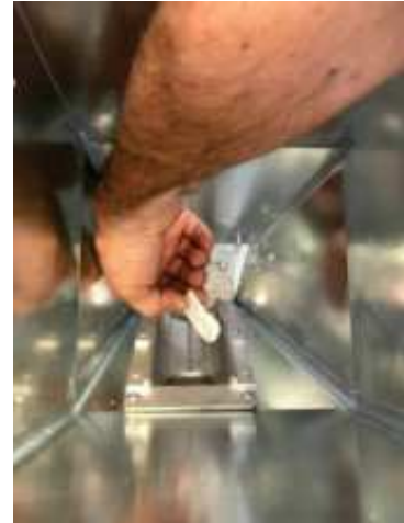
Fig. 58 - Extracción del cojinete
