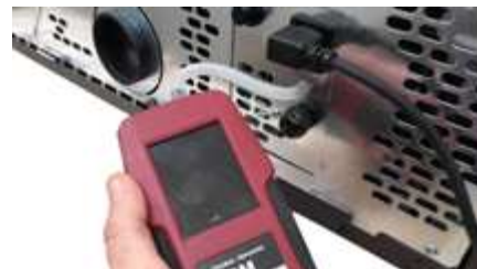
Fig. 53 - Conexión del presostato digital Modo At y Quasimod³ Up
