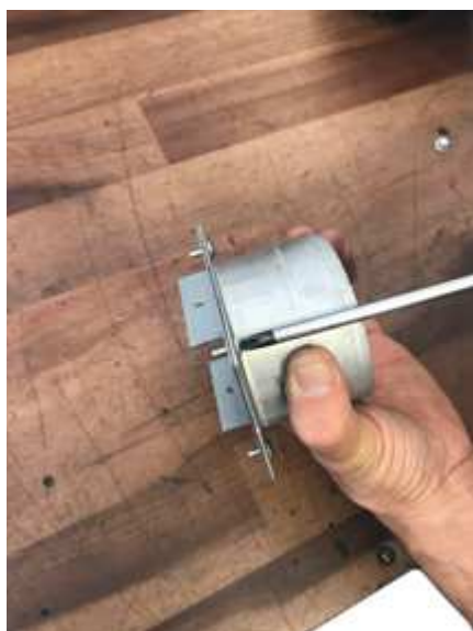
Fig. 31 - Fije la abrazadera al racor
