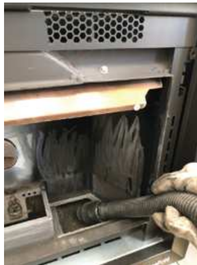
Fig. 70 - Aspire las cenizas
