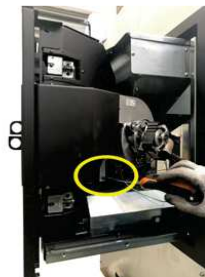
Fig. 61 - Extraiga el ventilador
