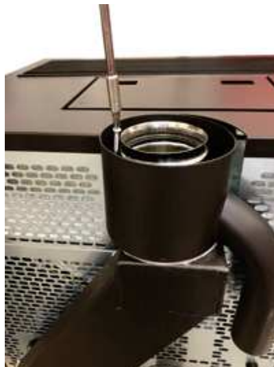
Fig. 44 - Fijar el tubo concéntrico
