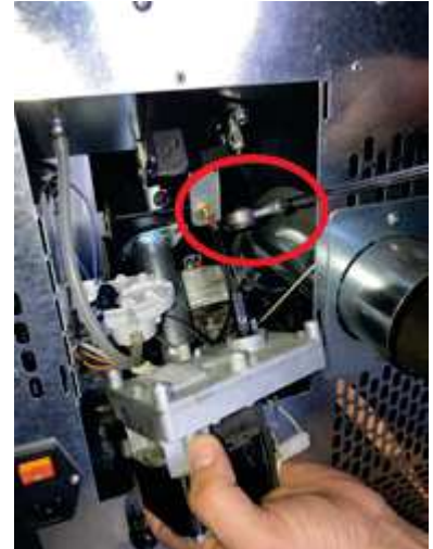
Fig. 56 - Extracción del motorreductor
