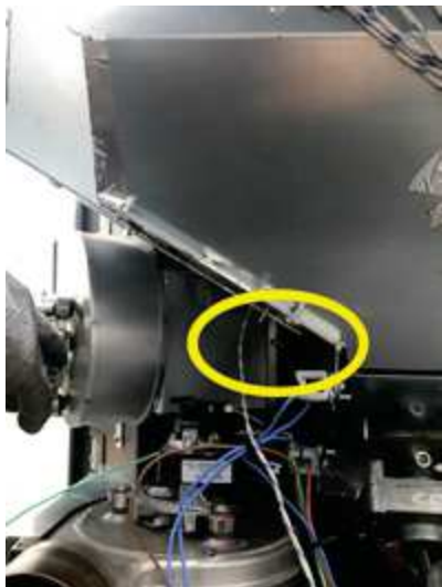
Fig. 59 - Afloje el tornillo
