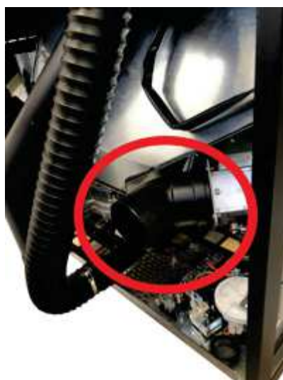
Fig. 38 - Coloque el racor de 45°
