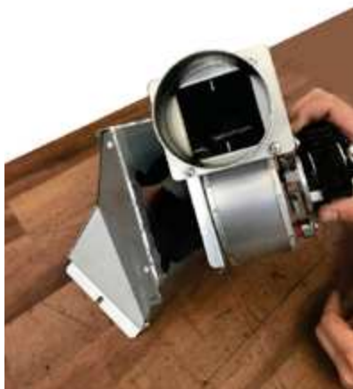
Fig. 35 - Fije el ventilador al cárter
