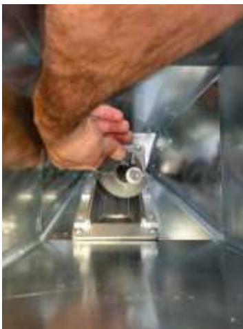
Fig. 57 - Extracción de la espiral
