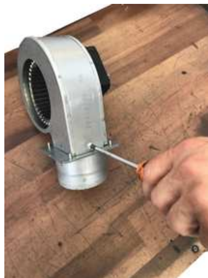
Fig. 33 - Fije con tornillos
