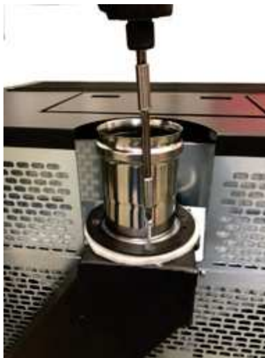
Fig. 41 - Desenroscar la descarga
