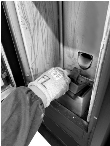
Fig. 21 - Extracción del brasero
