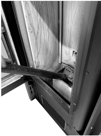
Fig. 23 - Limpieza alojamiento brasero
